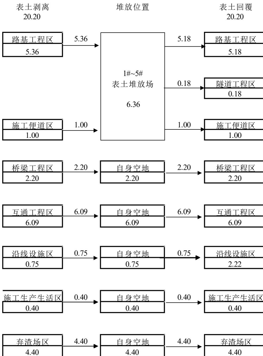
图2.6-6 工程表土流向平衡框图 单位: 万 m<sup>3</sup>
