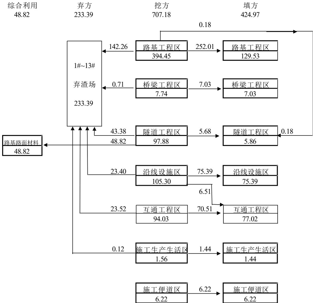
图2.6-5 工程土石方流向框图 单位: 万 m³
