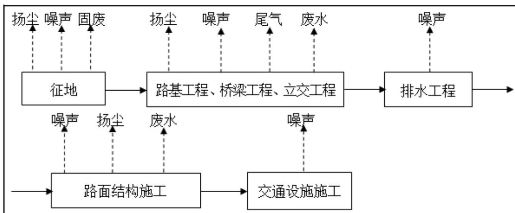
图2.7-3 一般路段施工工序及产污节点
