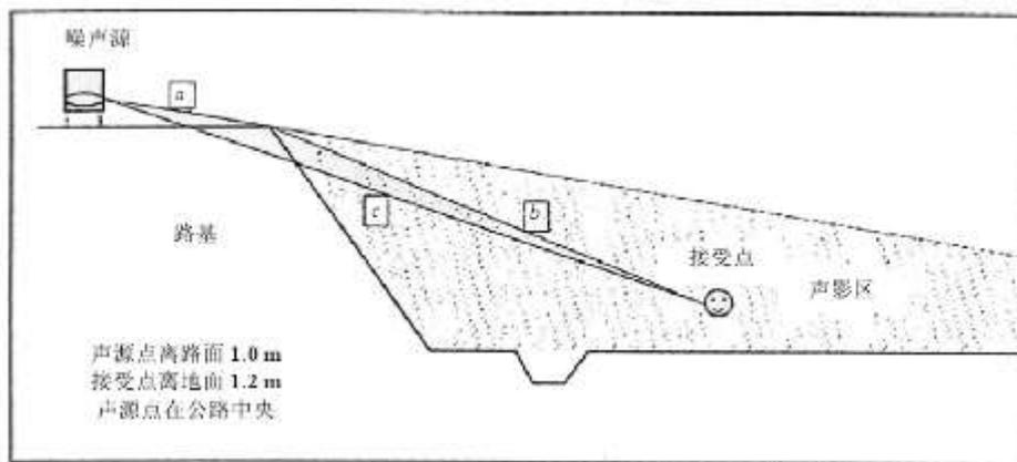
图4.4-3 声程差  $\delta$  计算示意图
