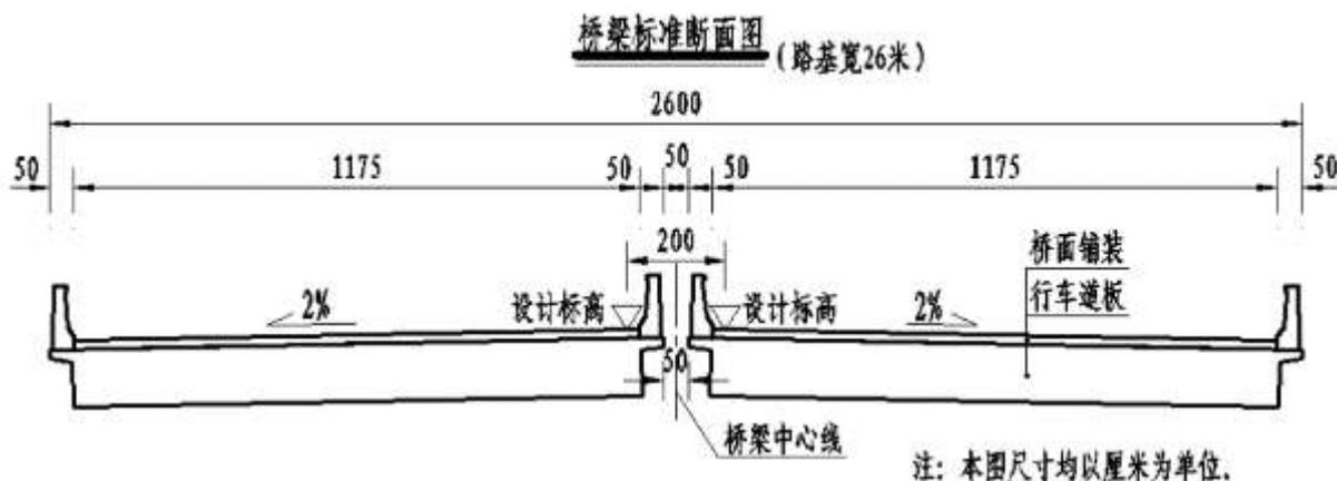
图2.6-3 主线桥梁标准横断面图
